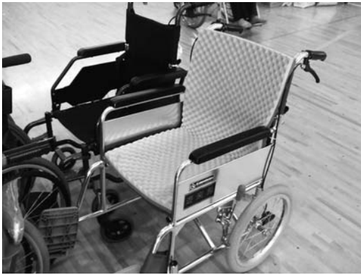
図6 ウレタンマットをつけた車椅子 実際は肘かけにもウレタンマットを敷いた。
