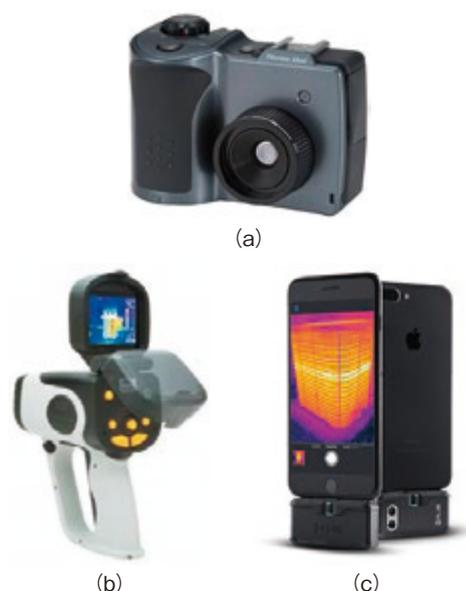
図2 臨床で使いやすい小型サーモグラフィーの機器例
